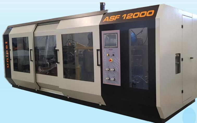
Máquina de sopro / estiramento linear modelo **ASF 12000** para fabricação de garrafas a partir de pré-formas.
